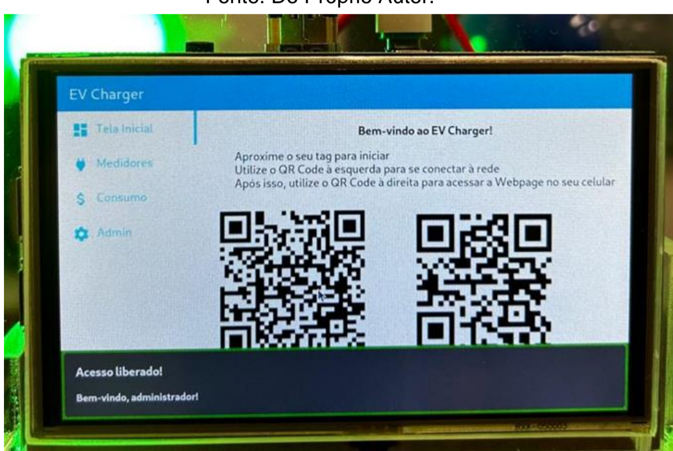
Figura 13 – Acesso liberado para Tags de Administrador Fonte: Do Próprio Autor.
